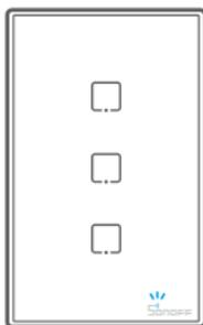
Después de encender, el dispositivo se pondrá en modo de emparejamiento rápido (Touch) durante el primer uso, El indicador LED de Wi-Fi entrará en "un ciclo de dos parpadeos cortos y uno largo".
