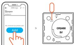
打开WeLink APP，选择要连接的网关，点击“添加”子设备，然后长按设备“RST”置量按钮5秒直至LED指示灯闪烁3下，设备进入配对状态，等待设备连接。
